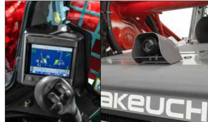
Übersichtliches Multifunktionsdisplay mit Einblendung der Rückfahrkamera.
