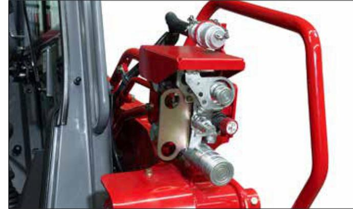
Durch den Zusatzsteuerkreis und den 14-poligen Zusatzstecker kann die Maschine für eine Vielzahl von Anbaugeräten verwendet werden.
