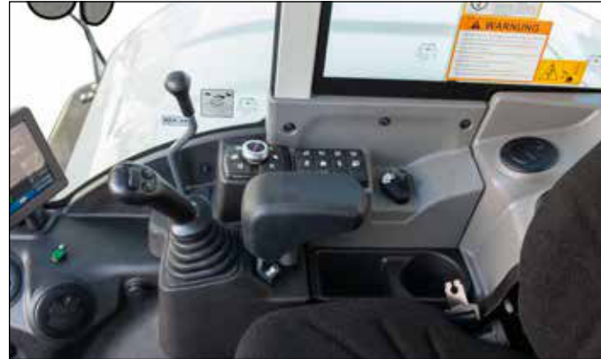
Proportionale Ansteuerung der Zusatzhydraulik über den rechten und linken Joystick. Neuer innovativer 3D-Bedienknauf für mehr Komfort.
