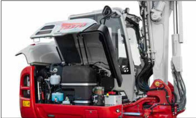
Verbrauchs-, abgas- und lärmreduzierte Motorengeneration für minimalen Verbrauch und selbstregenerierendem Rußpartikelfilter.
