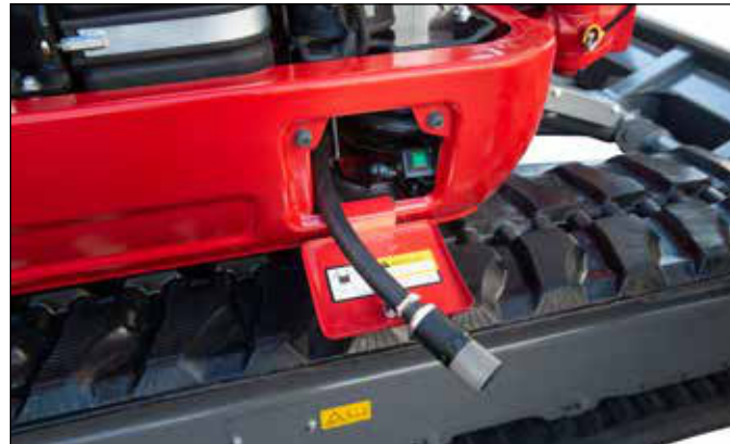
Eigenes Fach für Betankungspumpe und selbstaufrollendem Betankungsschlauch im Oberwagen.
