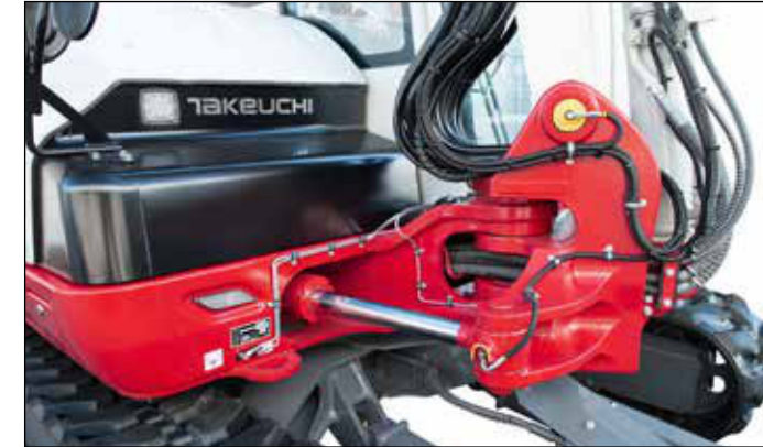
Robuster Schwenkbock. Schwenk-, Hub- und Stielzylinder mit Endlagendämpfung. Überlastwarneinrichtung und Schlauchbruchsicherung.
