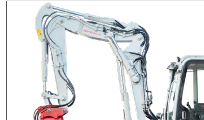
TB370 mit Verstellausleger erhältlich. 4 Steuerkreise, davon 3 proportional gesteuert, regulierbare Literleistung.
