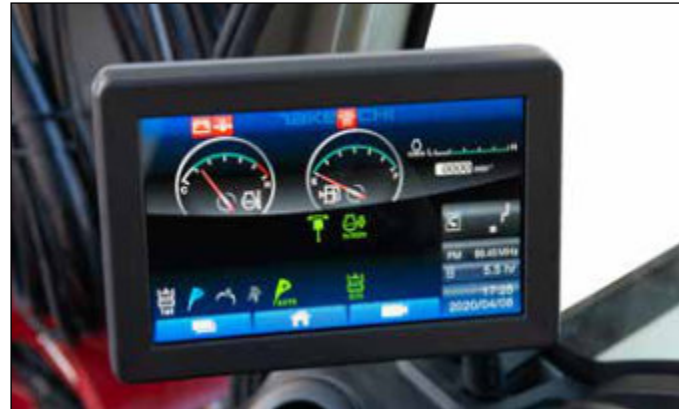
Neues 8" Multifunktions-Farb-Touch-Display: Werkstattnenü mit neuen Funktionen, automatische Einblendung der Rückfahrkamera, kratzfest, anlauffresistent.
