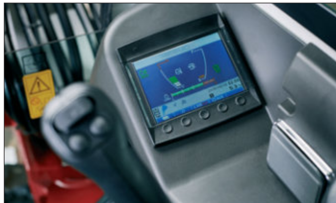
Přehledný displej přístrojové desky. ECO - režim ke zvýšení účinnosti a snížení spotřeby nafty.
