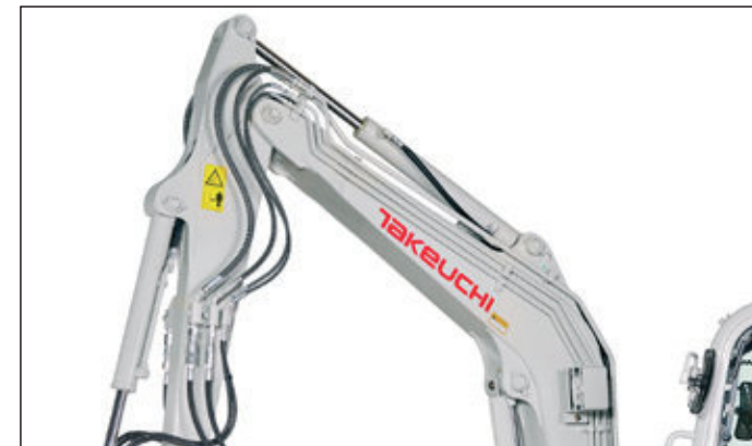
4 přidavné hydraulické okruhy, z toho 3 ovládané proporcionálně, průtoky regulovatelné na displeji.
