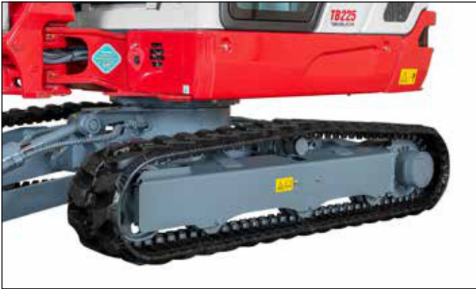
Rolny s vnitřním i vnějším vedením zamezují vyzutí gumového pásu, gumové pásy s krátkou roztečí minimalizují vibrace při jízdě.
