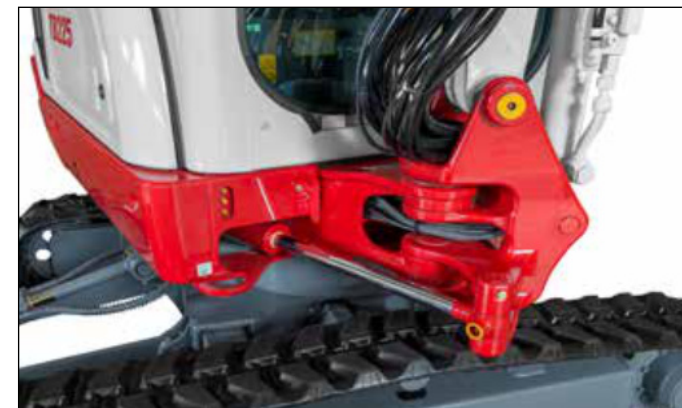
Robustní otočný kozlík se speciálně ochráněnými hadicemi i hydraulickým posuvem.
