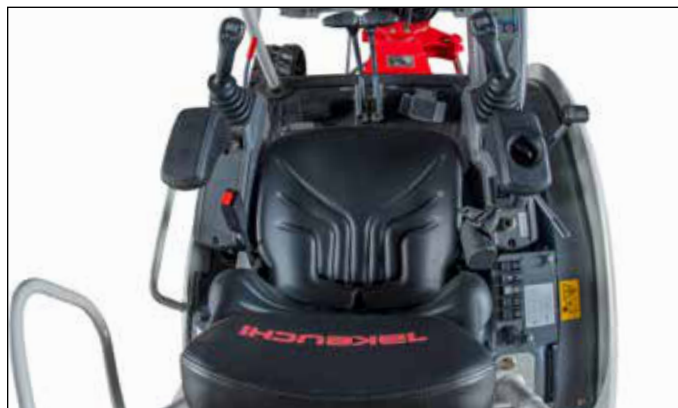
Proportionální ovládání přídavných okruhů pomocí joysticků.
