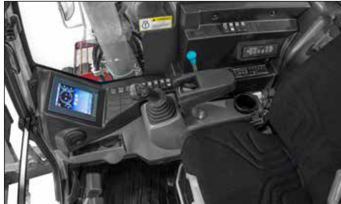
Velký, přehledný a uživatelsky příjemný displej s přepínáním zobrazení zadní kamery. Ergonomické uspořádání spínačů a ovládacích prvků.
