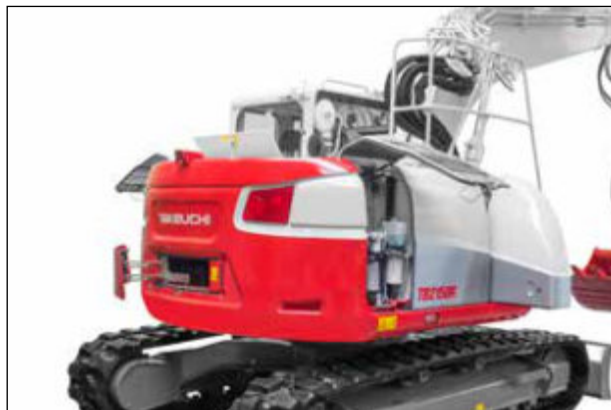
Zvýšené zadní závaží a ocelové kryty zajišťují stroji robustní ochranu při zachování výborného servisního přístupu.
