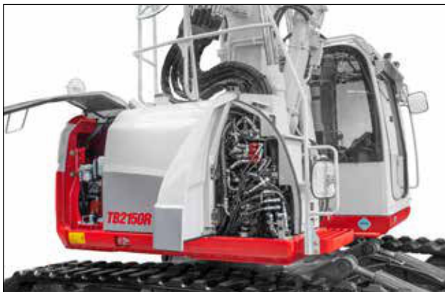
Pohodný servisní přístup k agregátům.
