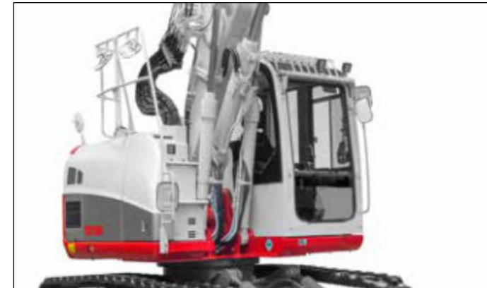
Inovativní vnější vedení hadic poskytuje speciální ochranu před poškozením.
