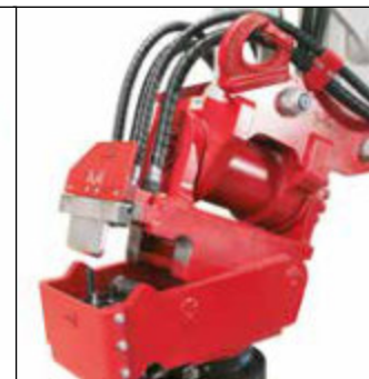
Systém Huppi-Quick: hydraulické okruhy jsou automaticky spojeny rychlospojkami
