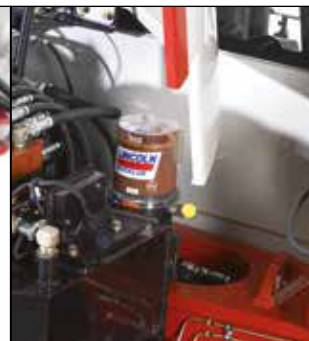
Centrální mazací systém s upozorněním při vyprázdňení maziva
