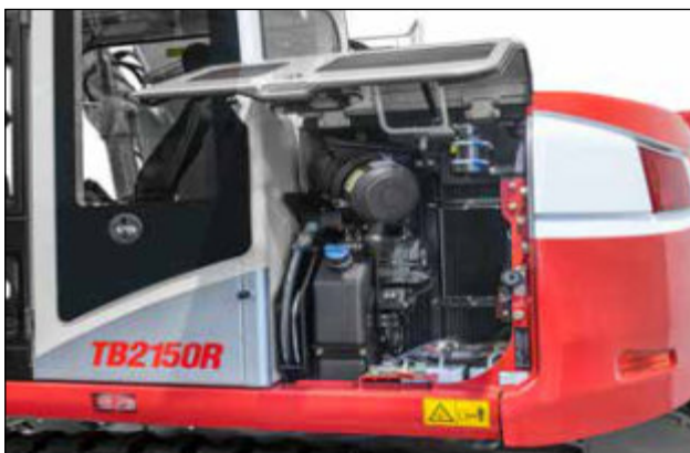
Inovativní a uživatelsky přívětivé plnění provozních kapalin díky snadno přístupnému umístění.
