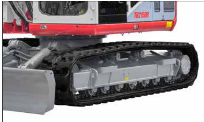
Dvojitě vodící rolny pásů a extra silná ozubená kola.
