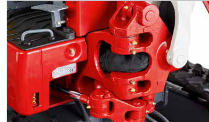
Robustní otočný kozlík. Hydraulický válec výložníku s tlumením koncové polohy.
