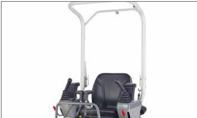
Ergonomické sedadlo s optimalizovaným rozmištěním ovládacích prvků pro usnadnění práce. Sklopný ochranný rám.
