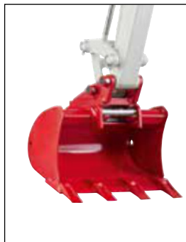
Mechanický rychloupínač. Lopatu je možné otočit i na tzn. "horovku".
