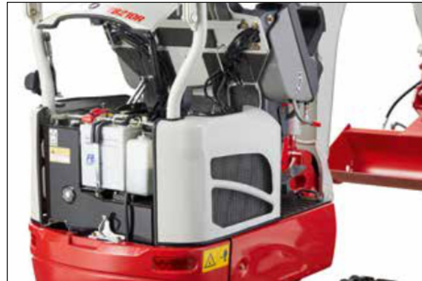
Velký ocelový kryt pro pohodlný servisní přístup k motoru a hydraulickým agregátům.
