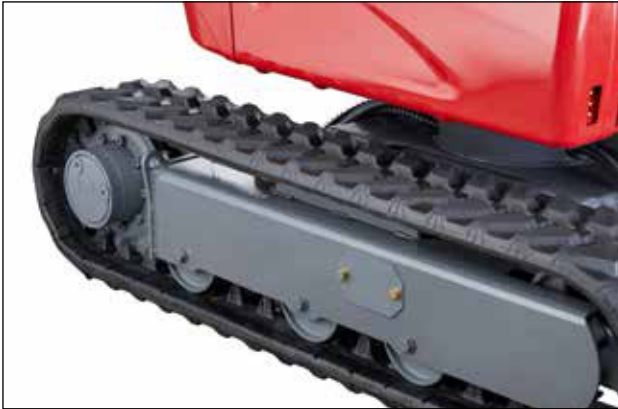
Rolny s vnějším vedením zamezují vyzutí gumového pásu, gumové pásy s krátkou roztečí minimalizují vibrace při jízdě.
