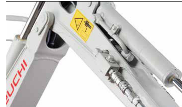
1 přidavný hydraulický okruh, ovládaný pomocí nožního pedálu.
